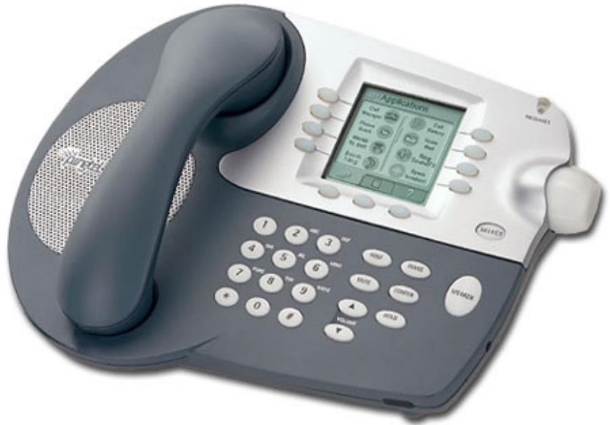
Figure 3a : Exemple de Terminal SIP à Grand Écran Tactile et Menus Contextuels (Pingtel)
